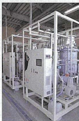
▲今回新たに2基追加した減圧蒸留器。これにより高純度のBDF精製が可能になるという
